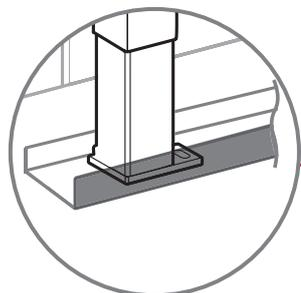
Verwendung eines UW-Trockenbauprofils als Bodenschiene erleichtert die fachgerechte Trockenbaubeplankung.
